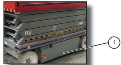
Rysunek 3-3. Mechanizm ochrony przed dziurami w nawierzchni
